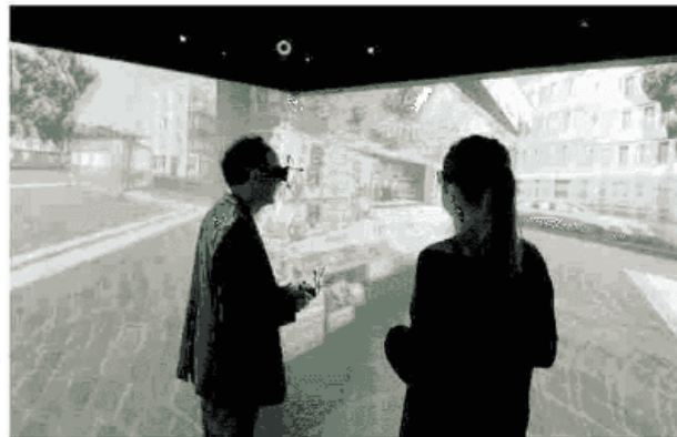
I «cave» sono stanze con schermi alle pareti e sul pavimento per proiettare le immagini 3D
